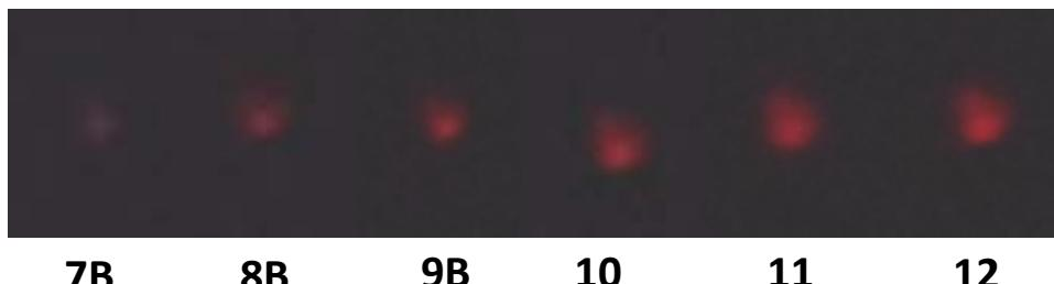
Рис.8. Свечение структуры n-GaP-n<sup>+</sup>(Si<sub>2</sub>)<sub>x</sub>(GaP)<sub>1-x</sub>, при подаче к нему прямого напряжения смещения.
