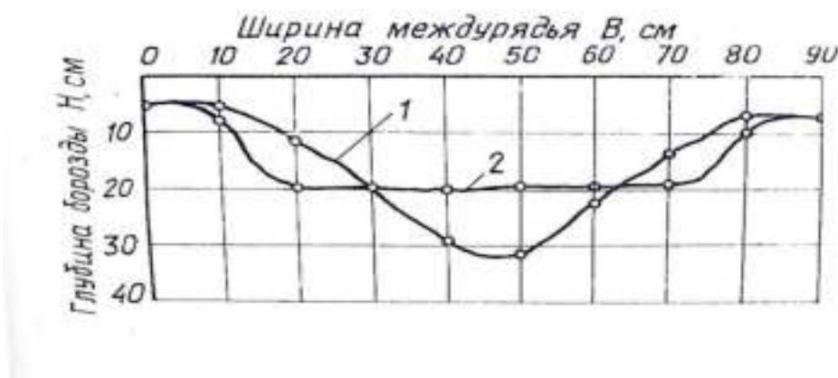
Рис: 4. Профиль междуурядья до (1) и после (2) прохода рабочих органов, установленных по варианту I
