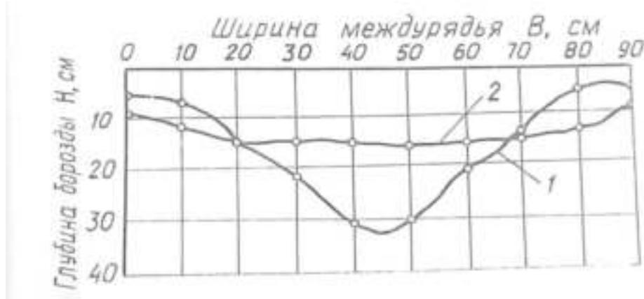
Рис: 6. Профиль междурядья до (1) и после (2) прохода рабочих органов, установленных по варианту III
