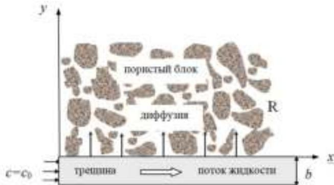
Рис. 1. Схематическое изображение переноса вещества и течения жидкости в ТПС.
