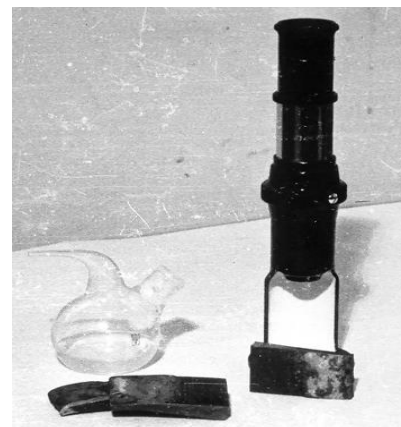
Рис.6 Применение МПБ-2 для измерения толщины
