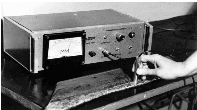
Рис.5 Измерение толщины с ТВТ-2 АНИТИМ. у образцов лезвий.
