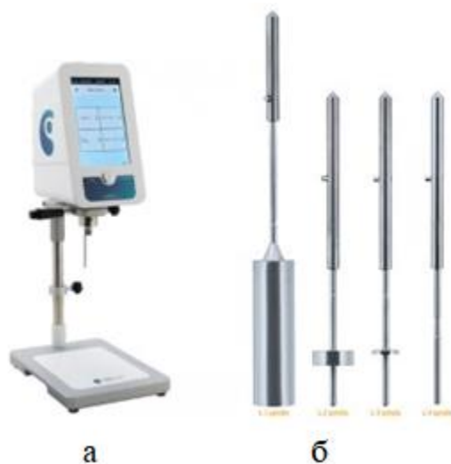
Рис. 1. Вискозиметр First Plus: а – общий вид; б - шпиндели
