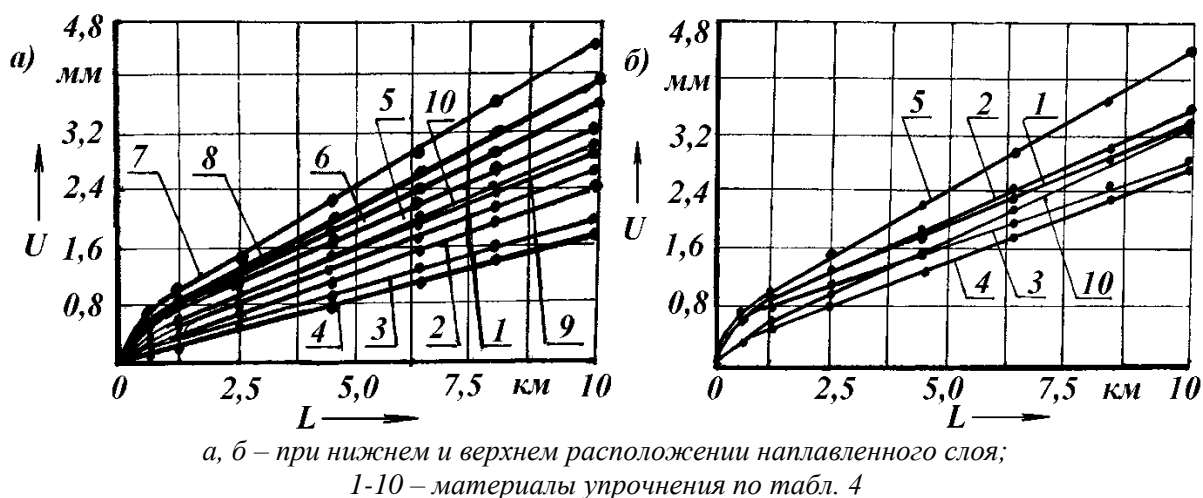
Рис. 9. Изнашивание лезвий в зависимости от материала упрочнения
