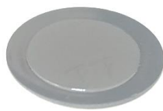
б) Внешний вид кремниевой пластины после механической обработки
