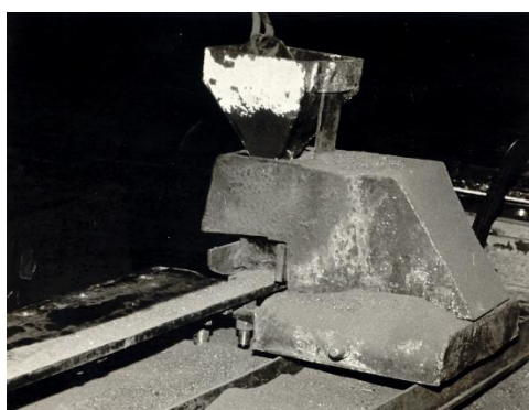
Рис. 3 Дозирующее устройство для насыпки шихты.
