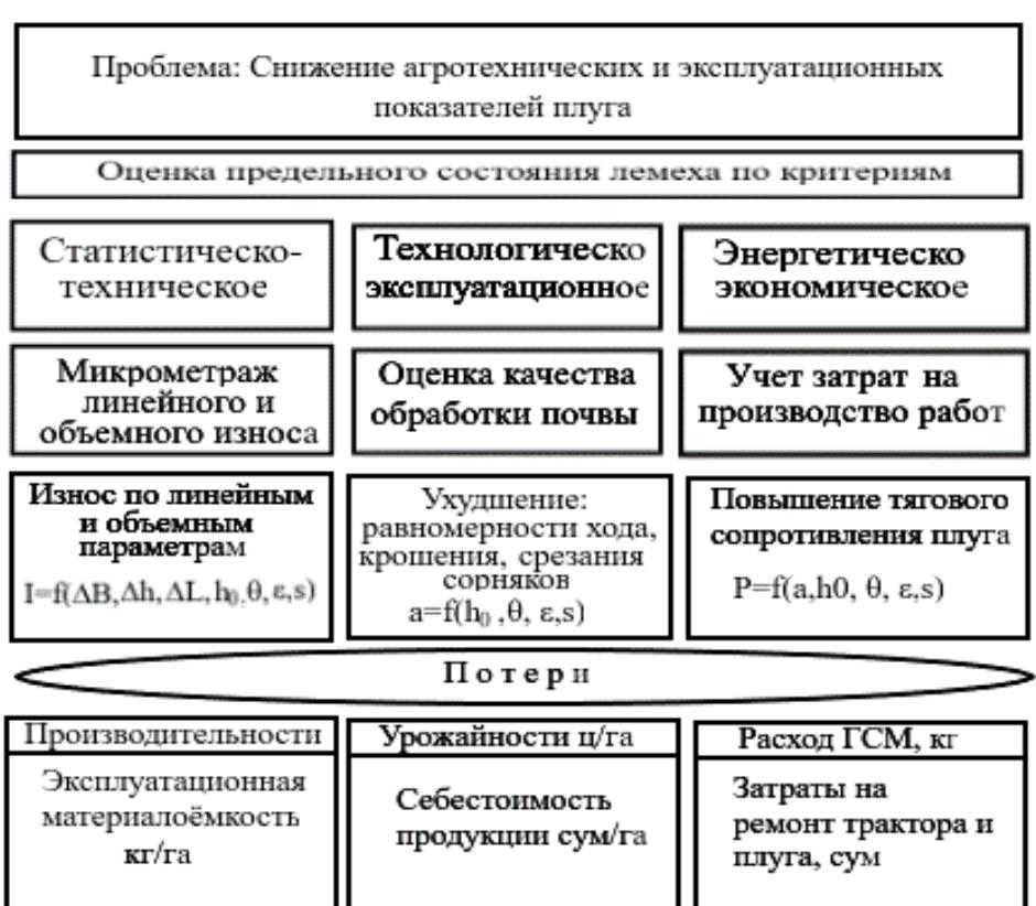
Рис.2. Блок-схема анализа снижения работоспособности (пределного состояния) лемеха плуга по критериям
